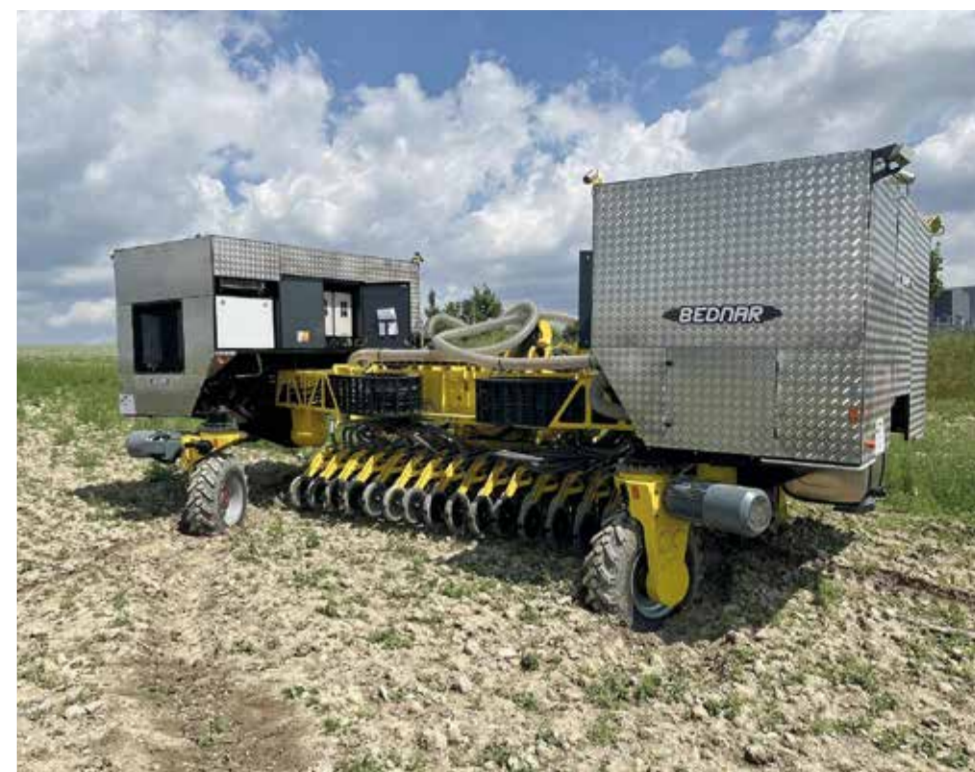
Robot s pracovním modulem pro seti při polních testech
